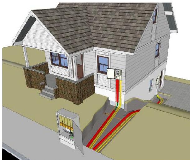
Figur 12-RT11059 - Stikkledning til tilknytningsskap innfelt i vegg - alt. 2
