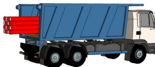
Figur 12 RT9201 - Under transport skal rør hvile på strøbord
